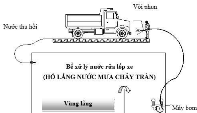
Hình 4.1. Sơ đồ nguyên lý bể xử lý nước rửa xe
