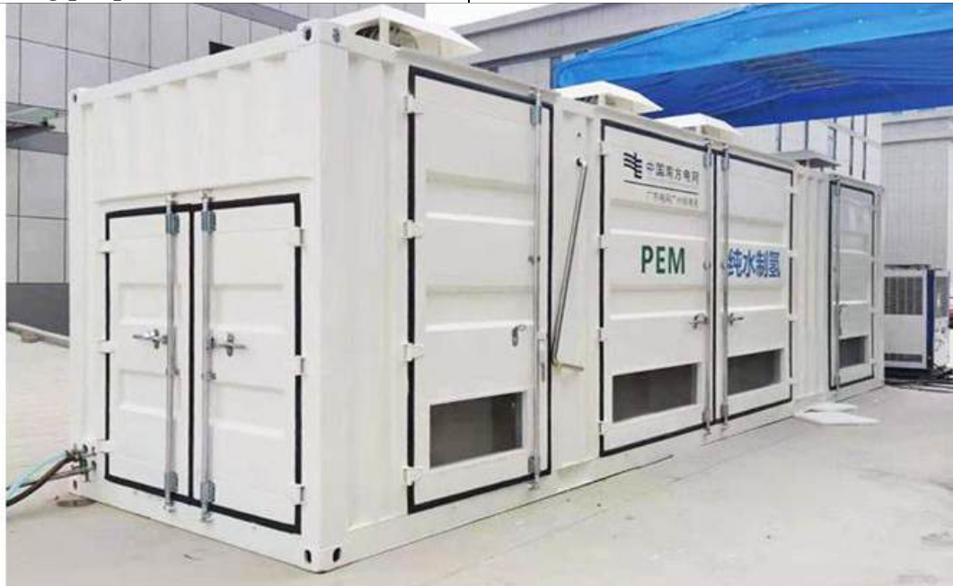
Hình 1.12. Mô tả thiết bị hợp khối sản xuất Hydro của dự án
